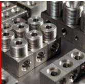
Komplettbearbeitung von kleinen bis mittleren Losgrößen auf modernen CNC-Fräsmaschinen mit bis zu 5 Achsen. Bearbeitungsgröße: X = 2.200 mm, Y = 750 mm, Z = 700 mm.
